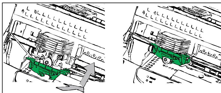
รูปที่ 1.5-4 กดตัวลือคหมึกพิมพ์ขึ้นไปหัวเครื่องพิมพ์และลือค
